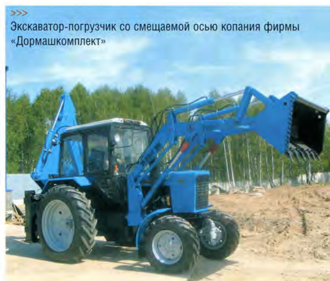
>>> Компактный экскаватор-погрузчик ЭО-1624А со смещаемой осью копания на базе трактора ВТЗ-2048А, выпускаемый Донецким экскаватором
